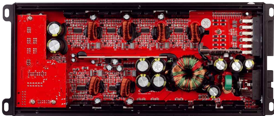
Sechs untereinander gleiche Kanäle teilen sich in Fullrange- und Subwooferkanäle auf
